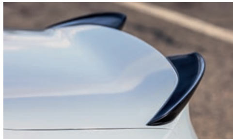
Die zwei kleinen Heckspoiler-Ecken sehen nach Spielerei aus. In Wahrheit sorgen sie für mehr Ruhe bei Topspeed
